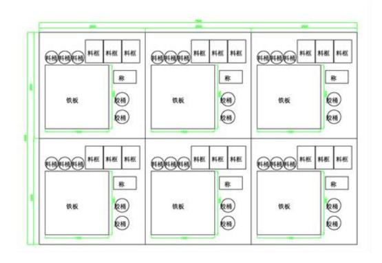
每一名参赛者都将拥有一个2.5m\*2.5m工作区域。这些工作区域中将包含一个1.5m×1.5m的混凝手工拌合台。三只50L圆料桶,三个54×42的塑料材料框。
